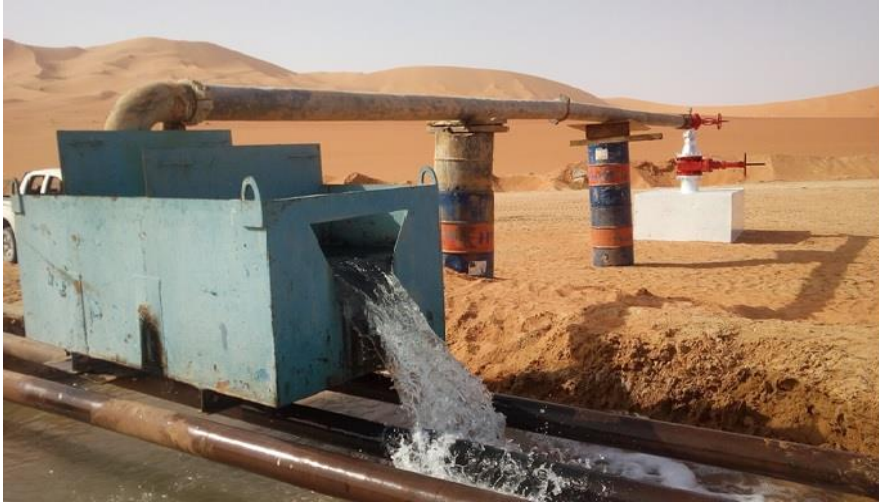
عملية اختبار الضخ في - بئر قلعة فاطمة - بالمنطقة الشرقية
